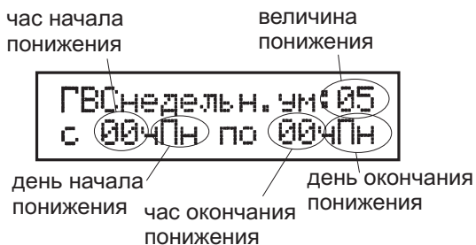
Рис.3.4. Настройка недельного понижения для ГВС
